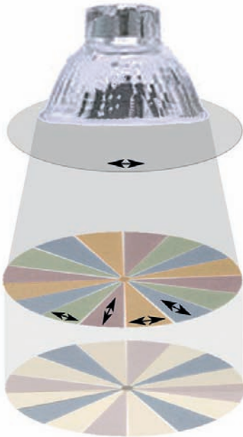
Bild 2: Strukturiert Polarisieren: Das linear polarisierte Licht der Quelle wird in den einzelnen Feldern unterschiedlich beeinflusst
